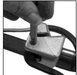
3. Para reemplazar el perno, el resorte debe ser colocado en el asiento del tornillo de tensión que está en la mordaza y alinie el barreno del perno con la mordaza y la entalladura de la herramienta e inserte el perno con un martillo.
