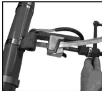
5. Gire la herramienta sobre la hebilla, regresando la manija de tensión 1 - 1½ vueltas, cuando se esté llevando a cabo la operación del giro. Si no hace el retroceso de la manija de tensión a lo largo del proceso de giro de la herramienta hacia la hebilla puede causar que se rompa la cinta. No hay pérdida de tensión en la sujeción ya que la liberación de la cinta se usa para facilitar el giro hacia arriba de la herramienta y el doblar de la cinta.
