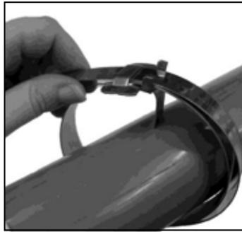
2. Para el caso de doble vuelta lleve la cinta nuevamente a través del elemento a sujetar y a la hebilla como se muestra. La doble vuelta nos da una mayor compresión radial que una sola vuelta. Doble el extremo de la cinta de lado de la hebilla debajo de ésta como se ilustra.
