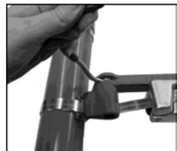
6. Gire el mango de corte hacia adelante para cortar la cinta. Cuando se estén formando abrazaderas con Fleje Gigante, antes de cortar la cinta, libere la mordaza y empuje la nariz de la herramienta aproximadamente a ¼" de distancia de la hebilla, en el momento corte.
