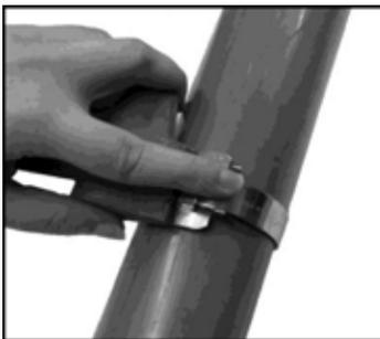
4. Coloque su dedo en la cinta BAND-IT en el Puente de la hebilla cuando este tensionando. En el momento en usted observe que la cinta detiene su movimiento hacia la hebilla se ha aplicado la máxima presión alrededor del elemento de trabajo. Detenga el giro de la manija de tensión.
