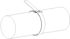
4. Coloque el cincho en el objeto que está sujetando. Jale el cincho envuelto a mano. Doble ligeramente la cola hacia arriba para mantener la abrazadera en su lugar.
